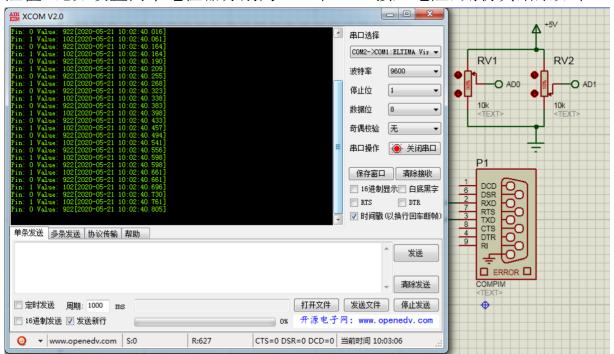
Arduino Uno 的 ADC 参考电压默认是 5V, ADC 为 10 位,输出 ADC 值一个为 102,一个为 922。同时板载 LED 闪烁。
