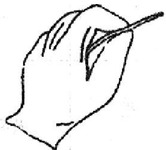
连续锡焊时焊锡丝的拿法
